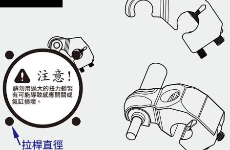
適用於拉桿直徑 8 ϕ 以下的拉桿缸
